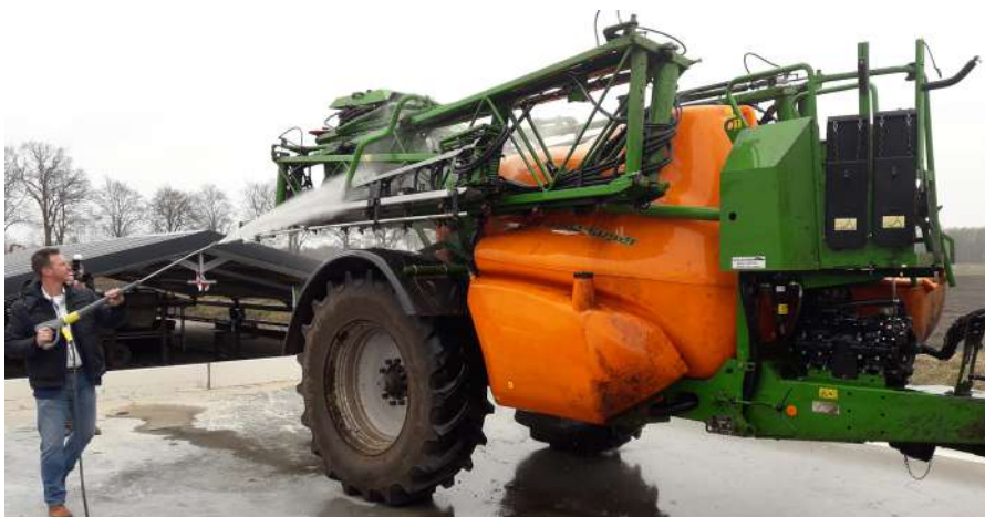
Figuur 14: Wasplaats voor spuitmachines zonder restlozing
